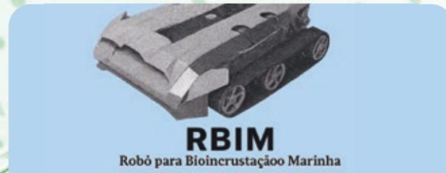
RBIM Robô para Bioincrustação Marinha RBIM - Robô para Bioincrustação Marinha, desenvolvido pelo SENAI CIMATEC remove bioincrustação em cascos de embarcações e estruturas offshore, reduzindo consumo de combustível e os custos de manutenção operacional.
